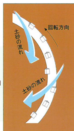
《図3》 図2の掘削刃のパターンの一例
